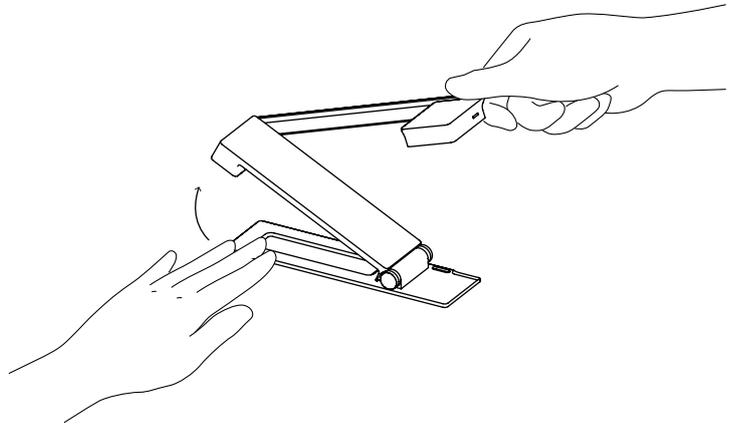
2. Drücken Sie gegen die Grundplatte der DO-CAM und ziehen Sie sie hoch.
